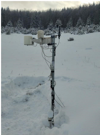
3. ábra. iMetos 3.3-as automata meteorológiai mérőállomás a Mohos-töbörben.
