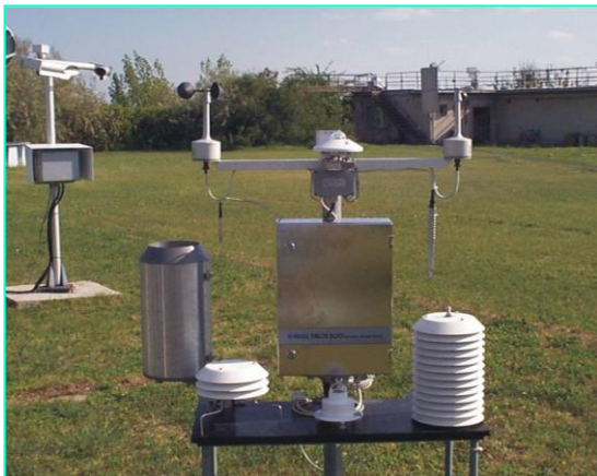
MILOS 500 automata meteorológiai állomás
